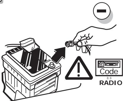
(DE) Um Störungen und Schäden am Bordnetz zu vermeiden, muss die Massepolklemme unbedingt vor Beginn aller Arbeiten von der Fahrzeughilfsbatterie getrennt werden! Insbesondere bei Arbeiten und Anschlüssen am CAN-Datenbus kann bei nicht abgeklemmter Batterie sowohl das Anhängermodul als auch das fahrzeugsseitige Bordnetzsteuergerät beschädigt werden! Bitte Herstellervorschriften beim Ab- und Anklemmen der Fahrzeughilfsbatterie beachten!
