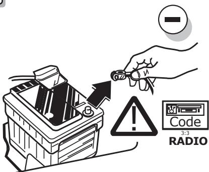
(DE) Um Störungen und Schäden am Bordnetz zu vermeiden, muss die Massepolklemme unbedingt vor Beginn aller Arbeiten von der Fahrzeughilfsbatterie getrennt werden! Insbesondere bei Arbeiten und Anschlüssen am CAN-Datenbus kann bei nicht abgeklemmter Batterie sowohl das Anhängermodul als auch das fahrzeugspezifische Bordnetzsteuergerät beschädigt werden! Bitte Herstellervorschriften beim Ab- und Anklemmen der Fahrzeughilfsbatterie beachten!
