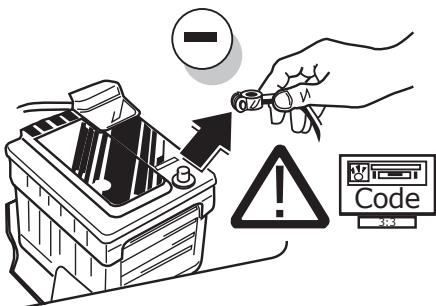
**(DE)** Um Störungen und Schäden am Bordnetz zu vermeiden, muss die Massepolklemme unbedingt vor Beginn aller Arbeiten von der Fahrzeubatterie getrennt werden! Insbesondere bei Arbeiten und Anschlüssen am CAN-Datenbus kann bei nicht abgeklemmter Batterie sowohl das Anhängermodul als auch das fahrzeugeitige Bordnetzsteuergerät beschädigt werden! Bitte Herstellervorschriften beim Ab- und Anklemmen der Fahrzeubatterie beachten!
